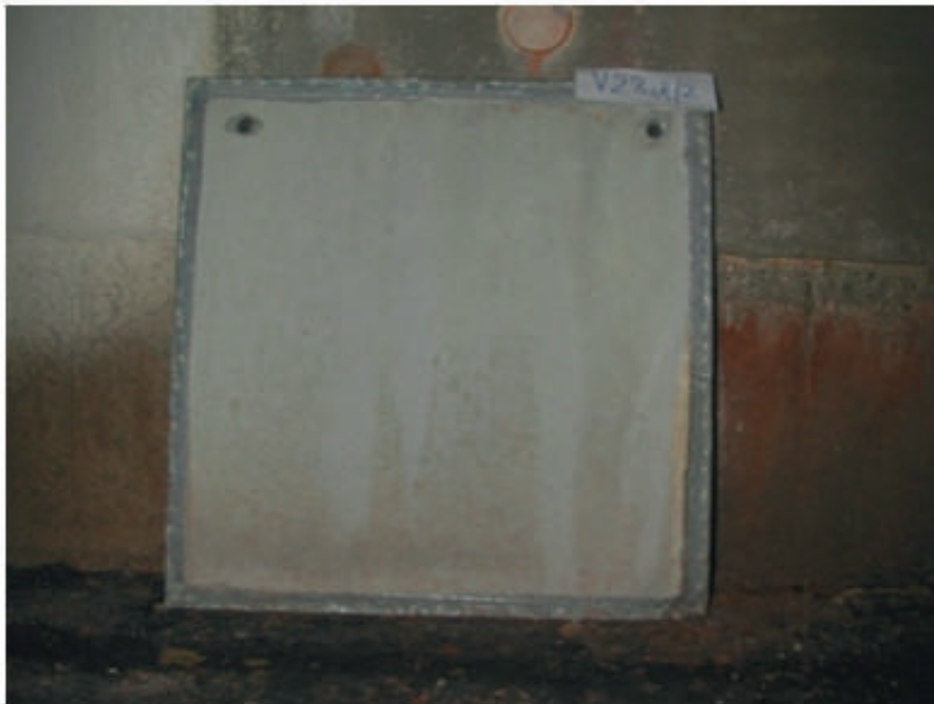
Muestra recubierta con POLYZEM Z modificado con polímeros después de la exposición a la zona de gas de H_2S del tanque de sedimentación final de la planta de tratamiento de aguas residuales Pro Rheno Basilea, Suiza.
